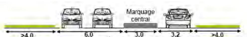
Figure 7 : Profil en travers projeté avec l'extension de la plateforme au niveau de Bonaparte Sud (Nouméa)
